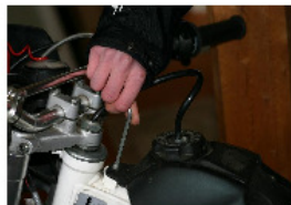
APRÈS AVOIR RETIRÉ LES FLANS, DÉPOSER LA VIS DE FIXATION SUPERIEUR DU RÉSERVOIR A L'AIDE D'UNE CLÉ ALLEN DE 5.
